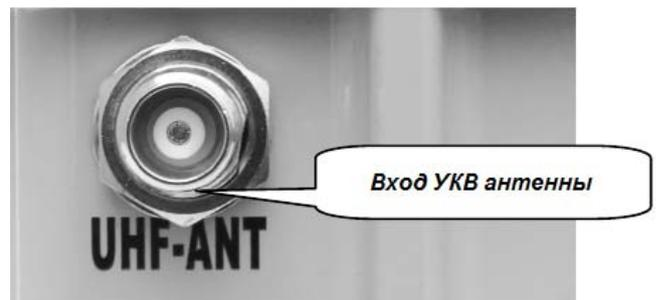
Вход для подключения передающей антенны
