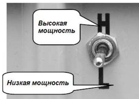
Рисунок 2.10 Переключатель уровня мощности сигнала
