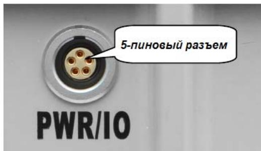
Разъем для соединения с GPS приемником и подключения источника питания
