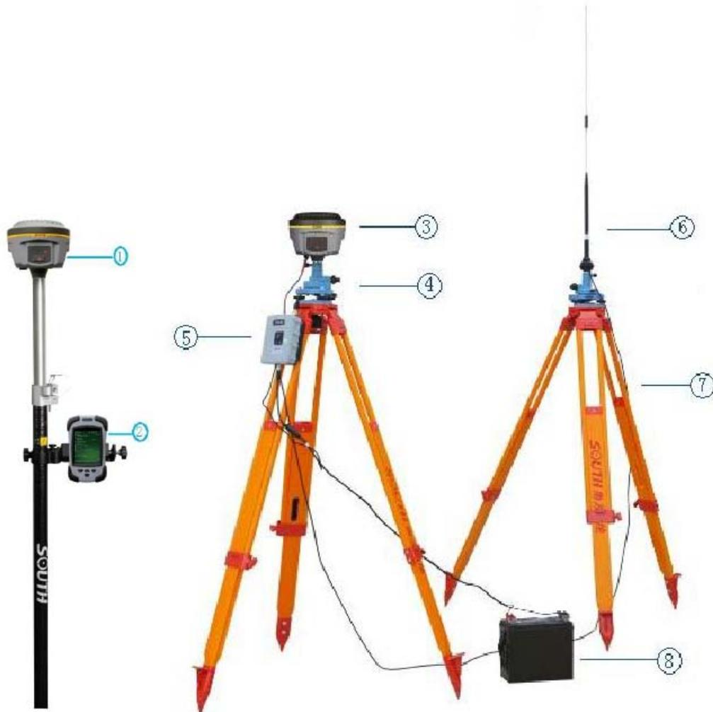
Рисунок 2.1 Ровер и базовая станция
